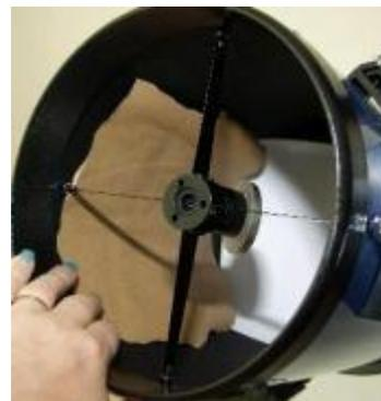
Tarjeta de color aplicada al tubo del telescopio para permitir que el secundario se muestre más claramente.
