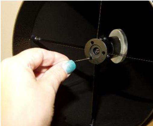
Primero retire la tarjeta de color y la tarjeta blanca "deflectora" del tubo del telescopio. Ahora mire dentro de la tapa de colimación y, utilizando los tornillos de inclinación, tenga a la vista todos los clips de retención de los espejos primarios y en el borde del espejo secundario. **¡IGNORE TODA LA OTRA INFORMACIÓN VISUAL!** Todo lo que intenta hacer en esta etapa es centrar el espejo secundario en el espejo primario.
