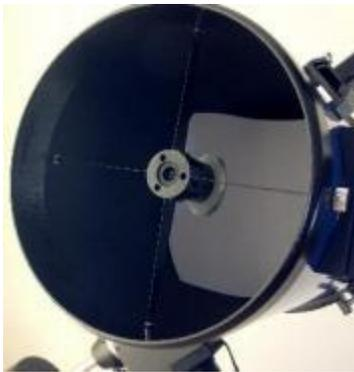
Tarjeta blanca insertada en el tubo del telescopio para bloquear los reflejos en el secundario.
