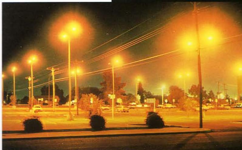
**BUENA ILUMINACIÓN.** Los expertos prefieren la luz amarilla que proyecta la iluminación de sodio, eléctricamente suficiente. El diseño de luces de este aparcamiento (izquierda) es un ejemplo, igual que las puertas de la fábrica (arriba), aunque éstas están todavía mejor iluminadas, porque la instalación bien proyectada tiende a dirigir la luz hacia abajo, donde es más necesaria.
